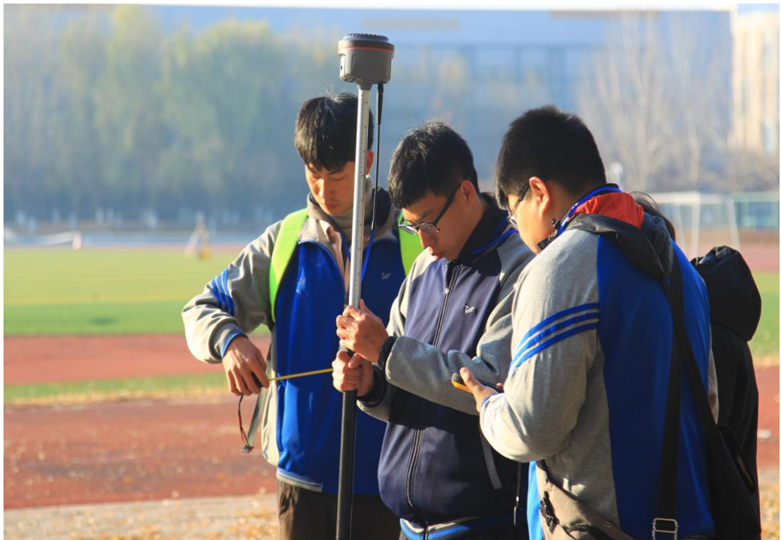
参赛选手采用卫星定位仪器测图
